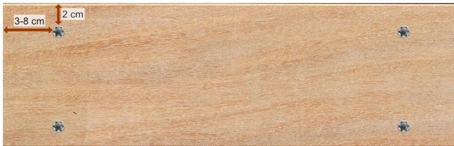
Schraubenempfehlung bei Verwendung einer Holzunterkonstruktion 45x70mm:
